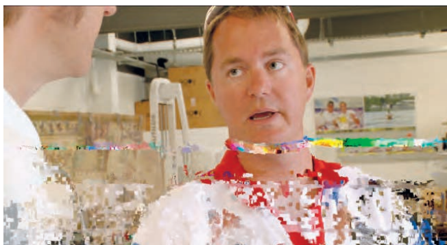
รูปที่ 9 แสดงอาการภาพแตกเป็นจุด เนื่องจากระดับของสัญญาณต่ำเกินไป
