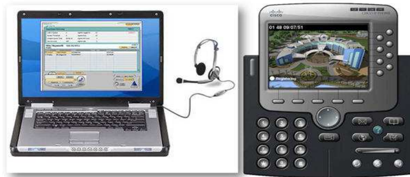
รูปภาพที่ 19-2 Softphone Client ที่ใช้กับคอมพิวเตอร์และ Conference Device
