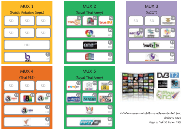
รูปที่ 2 แสดงการจัดสรรมัลติเพล็กซ์ (MUX) สำหรับช่องรายการโทรทัศน์ระบบดิจิตอลในปัจจุบัน
