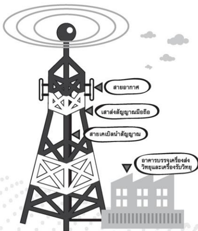
สถานีฐานระบบโทรศัพท์มือถือ
