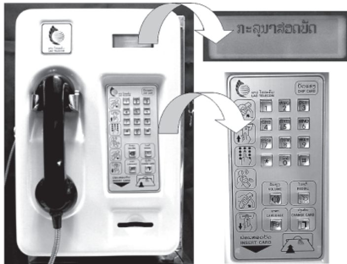
รูปที่ 6 แสดงเครื่องโทรศัพท์สาธารณะแบบใช้บัตรแข็งที่วิจัยและพัฒนาโดย บมจ.ทีโอที
