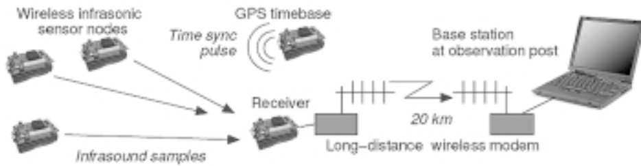
รูปที่ 8 โครงสร้างระบบเฝ้าระวังการระเบิดของภูเขาไฟ
