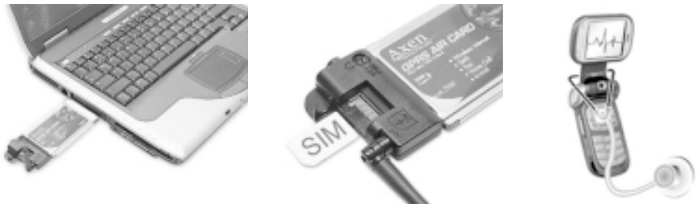
รูปที่ 20 การใช้ Air card และ SIM โทรศัพท์เคลื่อนที่ เชื่อมคอมพิวเตอร์เข้าสู่ระบบอินเทอร์เน็ต สำหรับรองรับการทำงานของระบบในเฟสที่ 1
