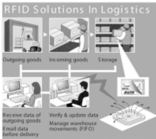
รูปที่ 10 การใช้ RFID จัดการในคลังสินค้า ( www.satoworldwide.com/rfid.html )
