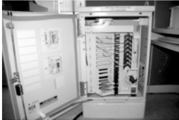
รูปที่ 8 อุปกรณ์ 1:32 splitter Module พร้อมทั้งตู้ cabinet แบบติดตั้งภายนอกอาคาร ซึ่งบริษัท ADC Krone นำมาร่วมการทดลองทดสอบ
