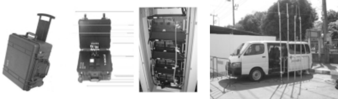
รูปที่ 8 แสดงถึงเครื่องตัดสัญญาณแบบรถเข็น แบบกระเป๋าหิ้ว แบบติดตั้งประจำที่ และแบบติดตั้งในรถยนต์
