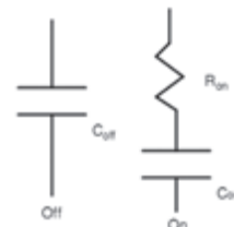
รูปที่ 8.4 วงจรสมมูลทางไฟฟ้า ของสวิตช์ MEMS แบบเมมเบรน
