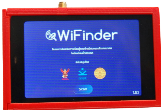
ภาพที่ 5 หน้าจอแสดงผลของเครื่องมือค้นหาแหล่งกำเนิดสัญญาณไวไฟ
