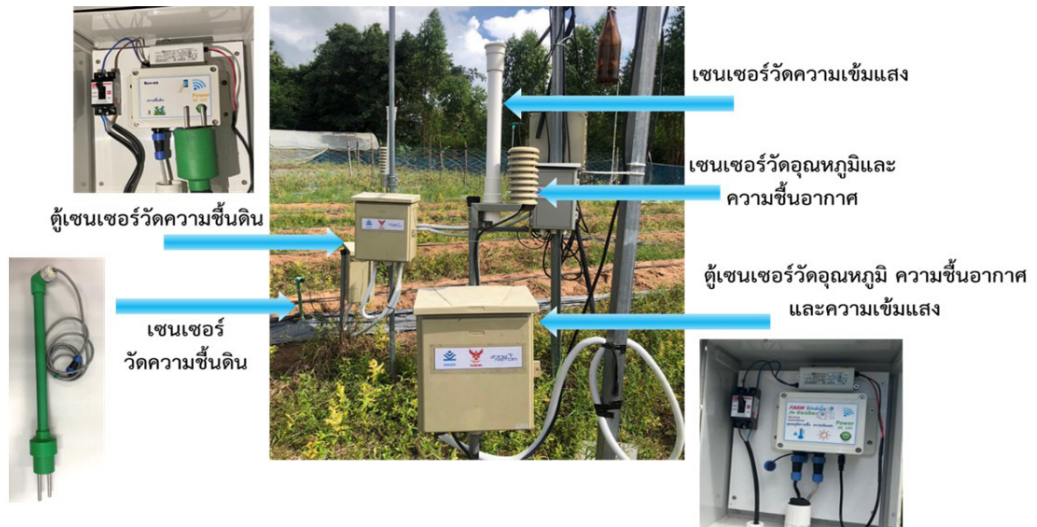
ภาพที่ 4 ตู้เซ็นเซอร์ประเภทต่าง ๆ ที่ใช้ในโครงการ
