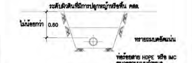
ขยายการฝังท่อ HDPE, IMC. SCALE NTS.
