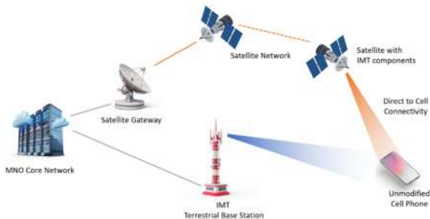
รูปที่ 3 ตัวอย่างของการทำงานระบบ Direct-to-Cell ซึ่งให้บริการลูกข่ายในกิจการโทรคมนาคมเคลื่อนที่สากล (IMT) ผ่านระบบดาวเทียมในกิจการเคลื่อนที่ผ่านดาวเทียม
