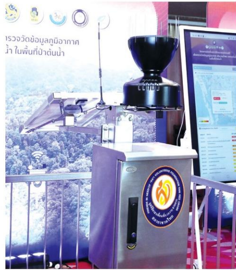
สถานีโทรมาตรอัตโนมัติ พร้อมติดตั้งบนพื้นที่ตอยสูง
