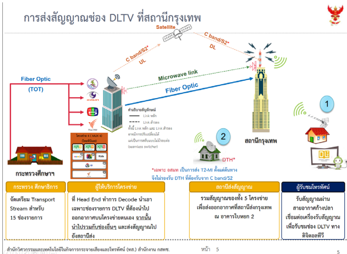
ภาพที่ ๒ การส่งสัญญาณโทรทัศน์ภาคพื้นดินในระบบดิจิทัลเพื่อการศึกษาที่สถานีกรุงเทพ
