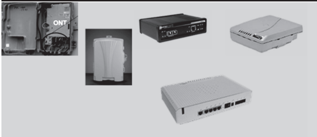
ภาพที่ 17: อุปกรณ์ ONU หรือ ONT
