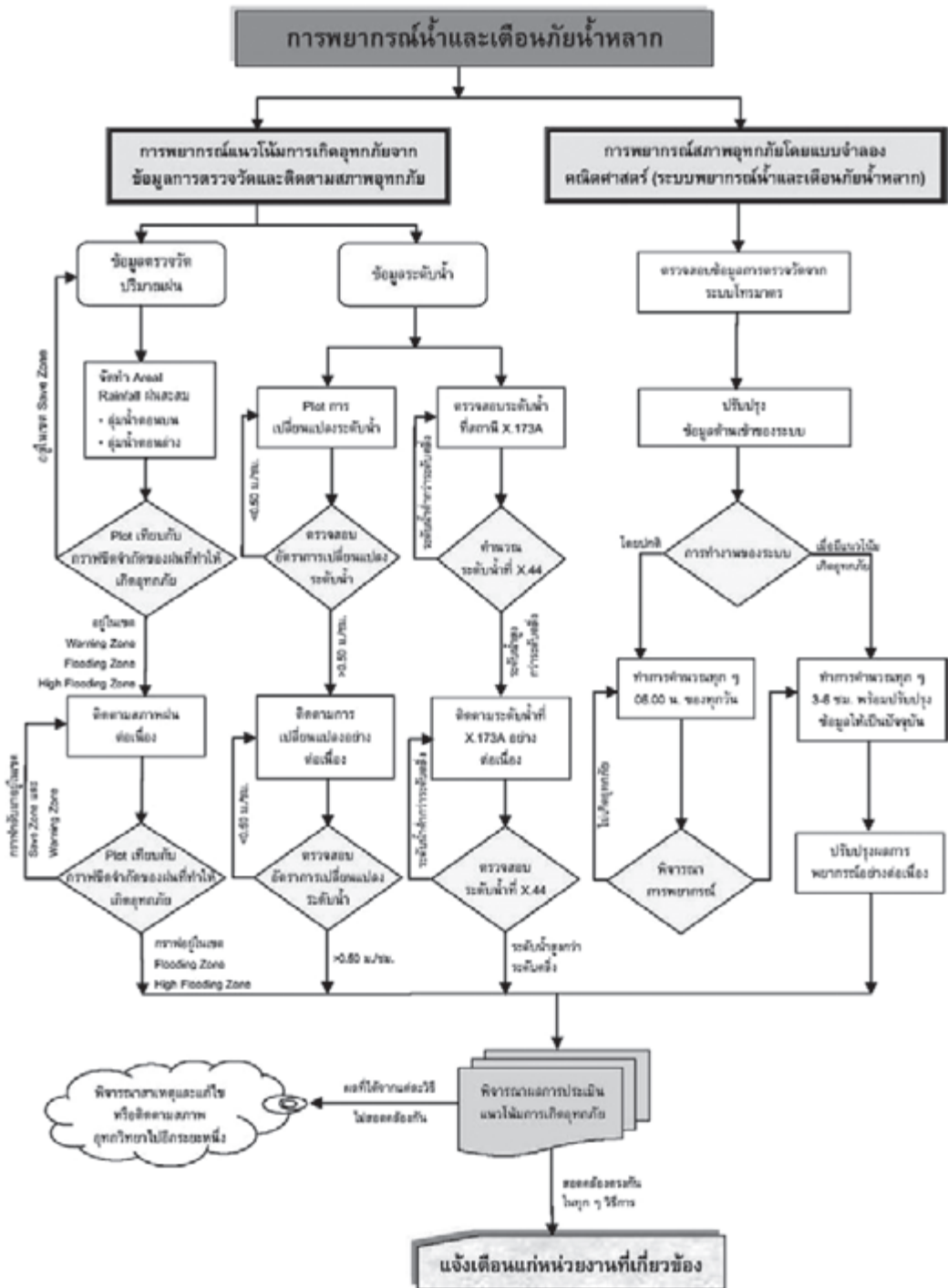
รูปที่ 4.7 แผนผังการบริหารจัดการอุทกภัยขนาดใหญ่
