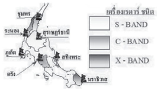
รูปที่ 2.11 สถานีเรดาร์ตรวจอากาศของกรมอุตุนิยมวิทยาในเขตภาคใต้
