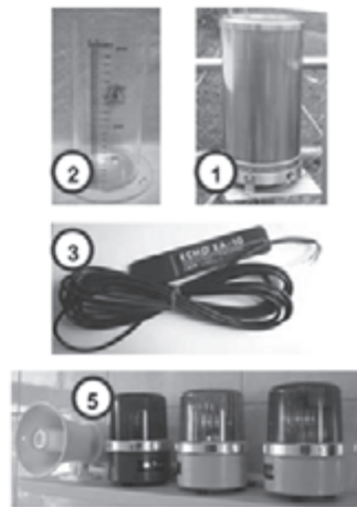
รูปที่ 2.8 สถานีเตือนภัยที่ใช้ น้ำฝนวิกฤติ ประกอบด้วย 1) เครื่องวัดปริมาณน้ำฝนแบบอัตโนมัติ 2) กระบอกวัดปริมาณน้ำฝน 3) เครื่องวัดความชื้นในดิน 4) เครื่องวัดอุณหภูมิ 5) สัญญาณเตือนภัยและลำโพง 6) ตู้อุปกรณ์
