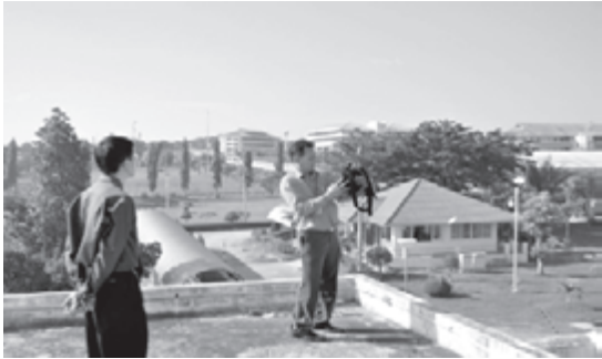
รูปที่ 16 การตรวจวัดสัญญาณภายในเรือนจำ หลังการติดตั้งเครื่องตัดสัญญาณ
